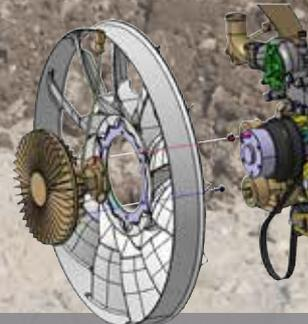
**Ventilateur à régulation électronique** : le régime du ventilateur est contrôlé par un embrayage hydraulique à régulation électronique. Les performances de refroidissement sont optimisées tandis que le ventilateur génère moins de bruit et consomme moins de carburant.
