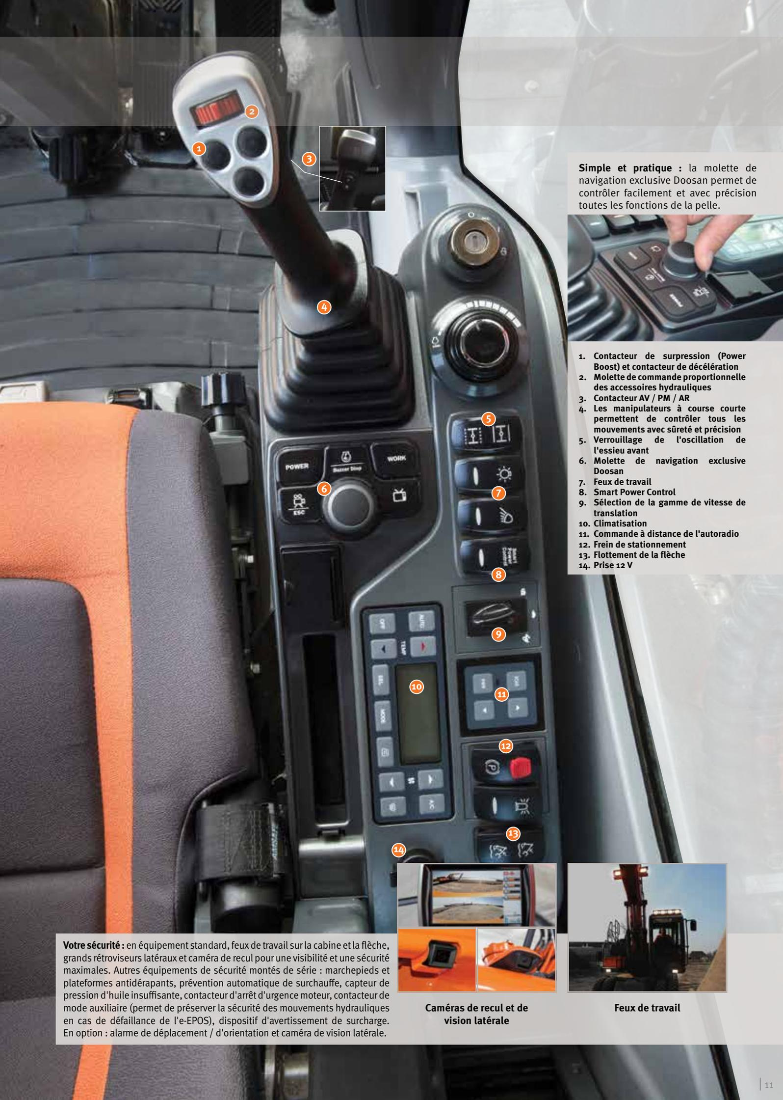
**Simple et pratique :** la molette de navigation exclusive Doosan permet de contrôler facilement et avec précision toutes les fonctions de la pelle.
