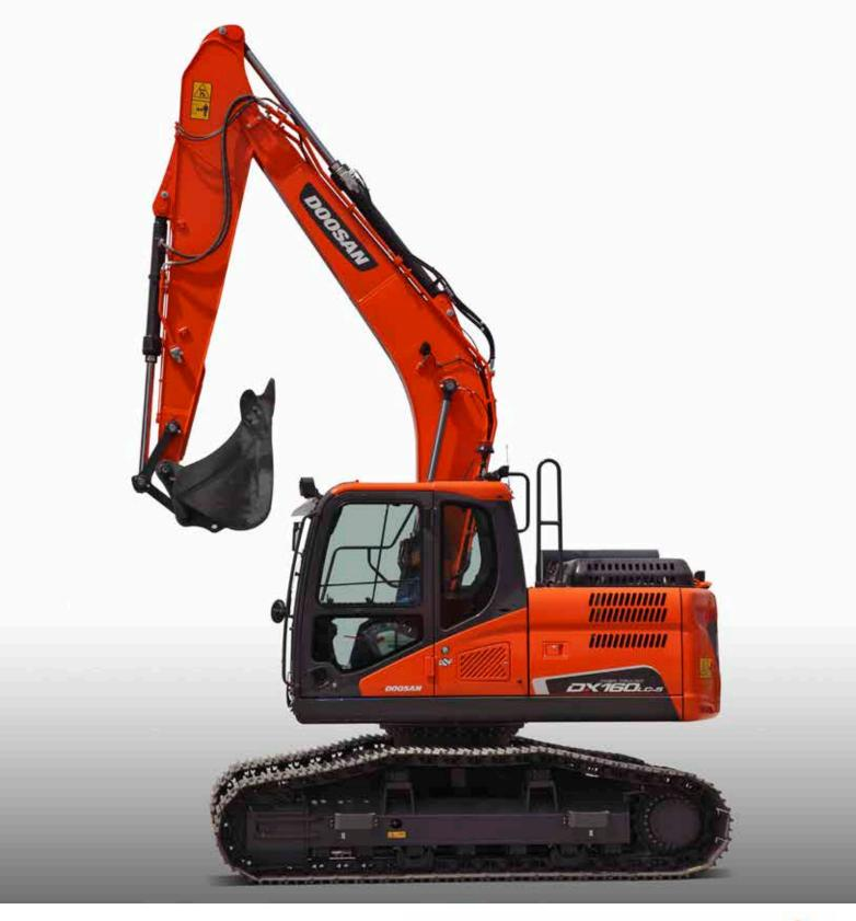
Puissance max. : 109 / 127 CV Poids opérationnel : 16,8 / 18,5 t Capacité de godet max. : 0,59 / 0,76 m³
