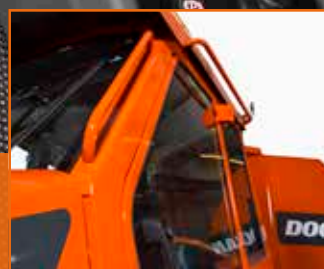
Mains courantes tout autour de l'extérieur de la cabine
